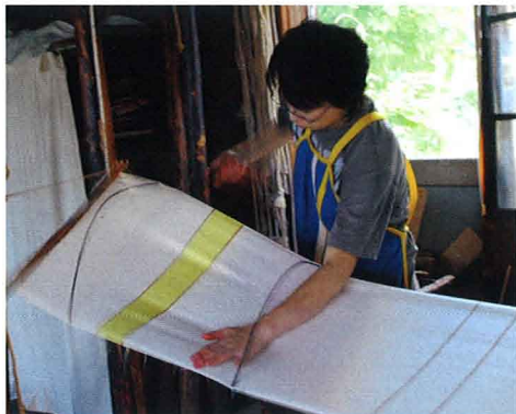
引き染の様子。反物の両端を引っ張りながら、刷毛に染料を含ませて染める技法だ
